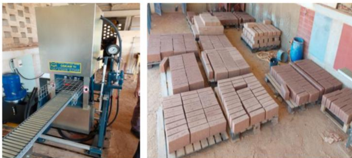
Figura 12 - Moldagem e compressão dos BTC (esquerda) e cura ao ar livre (direita) (Rodrigues 2024)
