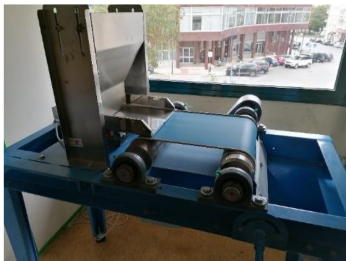
Figura 8 - Separador magnético de rolo com ímanes permanentes de terras raras (Nabais 2023)
