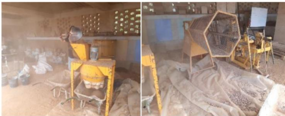
Figura 10 - Triturador de solo e peneira (Nabais 2023)
