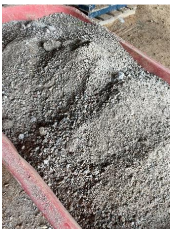
Figura 14 – Resíduo de construção e demolição
