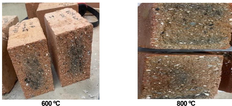
Figura 44 – Interior dos BTC com CRP e CP após exposição a diferentes temperaturas.
