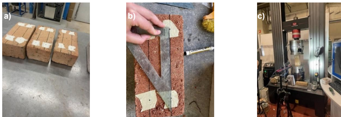
Figura 33 – a) Grelha; b) afastamento de 20 cm entre os pontos; c) provete na vertical e prensa Instron.
