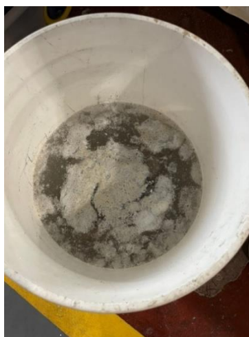
Figura 45 – Imersão em água de um BTC com CP após exposição a 1000 °C – Hidratação de cal livre.
