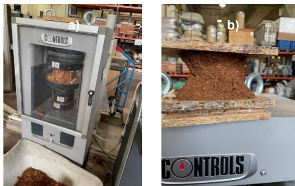
Figura 30 – a) Prensa com BTC e tábuas de contraplacado na parte superior e inferior do bloco; b) rotura do BTC à compressão.
