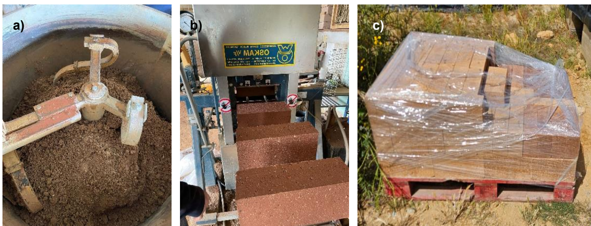
Figura 25 – a) Misturadora de eixo vertical; b) prensa hidráulica semiautomática OSKAM V/F e BTC não estabilizados recém prensados; c) BTC estabilizados embalados para o transporte.
