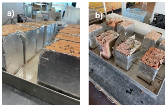
Figura 31 – a) Face inferior dos BTC submersa bem como faces laterais isoladas; b) tiras metálicas.
