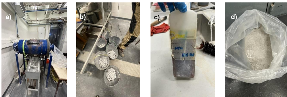
Figura 17 – a) Moinho de bolas; b) esferas metálicas; c) aditivo desfloculante; d) partículas de diâmetro inferior a 150 \mu\text{m} .
