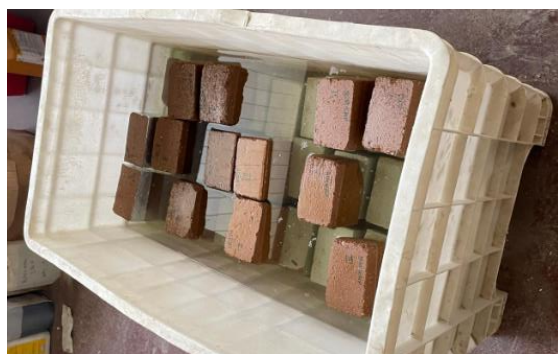
Figura 50 – Imersão dos BTC em água até massa constante.
