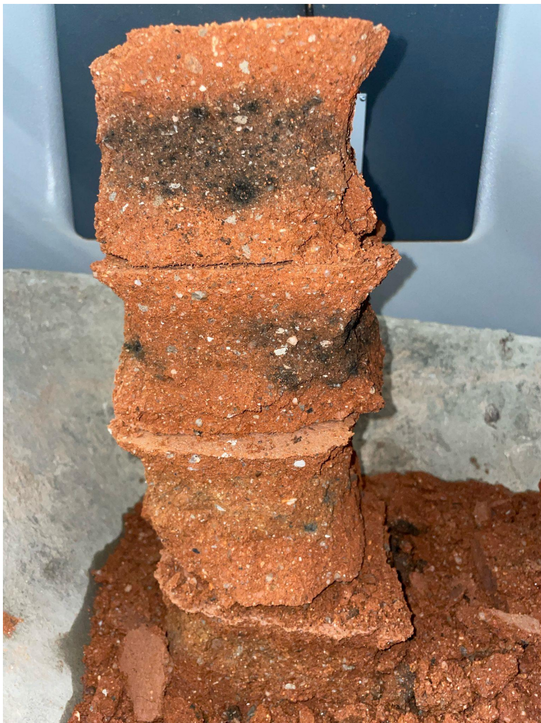
Figura A 16 - Modo de rotura dos blocos ensaiados à Compressão.
