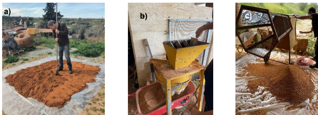
Figura 24 – a) Solo FA distribuído numa lona plástica; b) pulverizador de pás mecânico; c) crivo rotativo.
