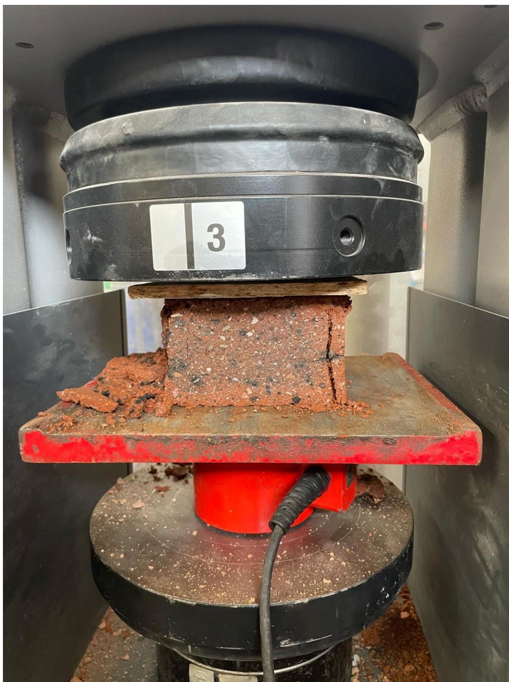
Figura A 15 - BTC NE ensaiado à Resistência à Compressão com a célula de carga na zona inferior da prensa.
