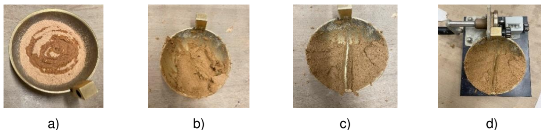
Figura 3.4 - Sequência do procedimento experimental para determinação dos limites de consistência. a) mistura da terra com água; b) Homogeneização da mistura; c) execução do sulco; d) junção dos bordos inferiores do sulco
