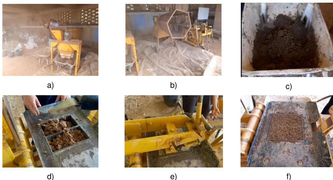
Figura 2.3 - Etapas para a produção de BTC: a) Pulverização. b) Peneiro com 4mm de abertura. c) Mistura húmida. d) Dosagem da mistura. e) Moldagem. f) Desmoldagem
