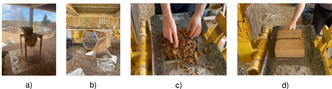
Figura 3.13 - Produção dos BTC; a) pulverização do solo b) peneiração do solo; c) colocação da mistura na prensa; d) desmoldagem dos blocos
