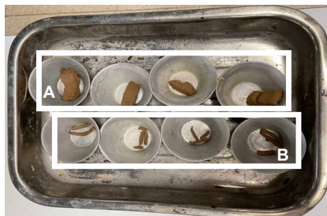
Figura 10: a) amostra – Limite de liquidez; b) amostra-Limite de plasticidade
