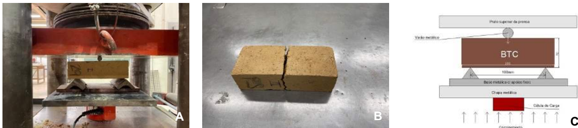
Figura 25: Resistência à tração por flexão- A) esquema de ensaio; B) bloco fracturado; C) Esquema ilustrativo do ensaio
