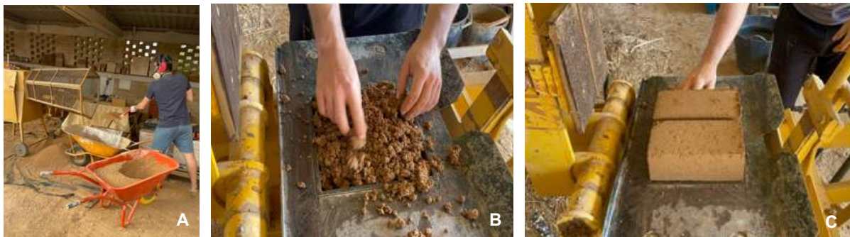
Figura 23: Produção dos BTC – a) peneiração do solo (malha de 8mm); b) colocação da mistura nos moldes; c) desmoldagem dos blocos;
