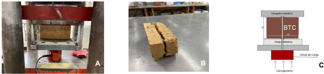
Figura 26: Ensaio à tração por compressão diametral - A) esquema de ensaio; B) bloco fracturado; C) Esquema representativo do ensaio – alçado lateral
