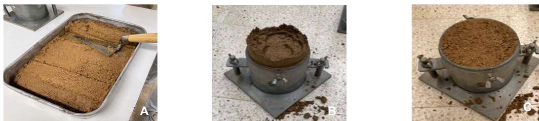
Figura 11: Sequência procedimento experimental – Ensaio de compactação; a) amostra dividida em 3 partes iguais; b) molde cheio sem alonga; c) molde cheio com superfície alisada
