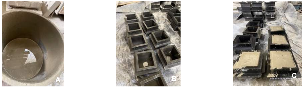
Figura 17: Produção de pasta de cimento hidratado – a) execução da mistura; b) preparação dos moldes cúbicos; c) colocação da mistura nos moldes
