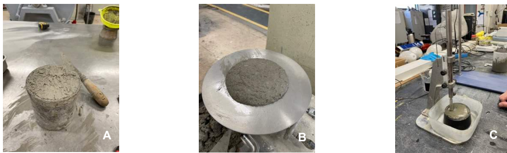
Figura 20: Ensaio de caracterização do CR – a) determinação da massa volúmica; b) avaliação da consistência; c) determinação de consistência de pasta normal e tempo de presa;
