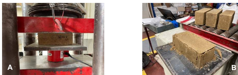
Figura 24: Resistência compressão - A) esquema de ensaio; B) bloco após ensaio;
