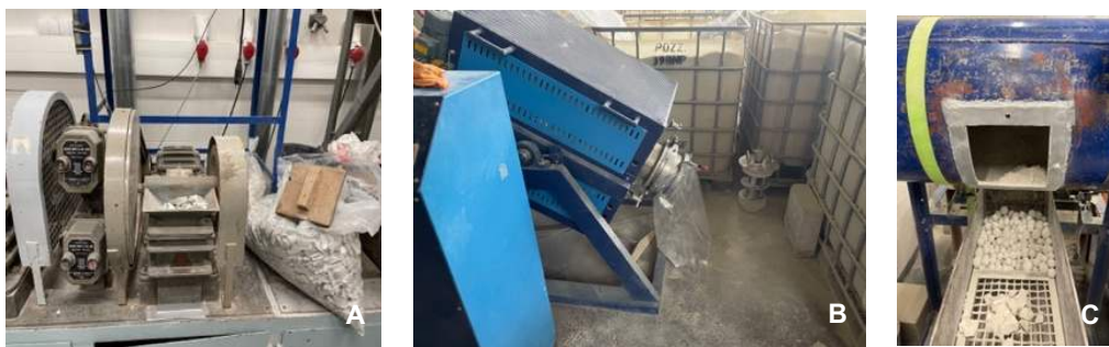
Figura 18: Produção de CR – a) moinho de maxilas; b) forno rotativo; c) moinho de bolas
