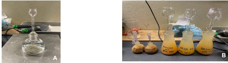
Figura 8: Determinação da massa volúmica - a) Calibração do picnómetro; b) picnómetros com água destilada e solo
