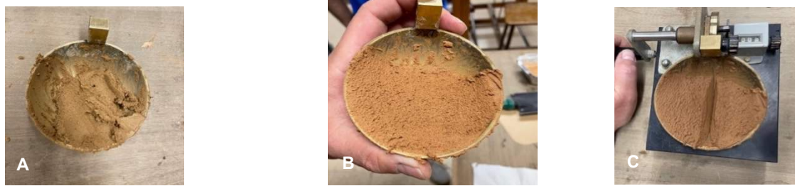
Figura 9: Sequência de procedimento experimental–Limites de consistência. a)homogeneização da mistura; b)distribuição da mistura pela concha de Casagrande; c)execução do sulco
