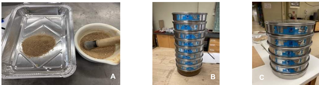
Figura 5: Análise granulométrica - a) Preparação da amostra - almofariz e pilão com cabeça de borracha; b) série de peneiros (75mm-2mm); c) Série de peneiros (2mm-0,075mm)
