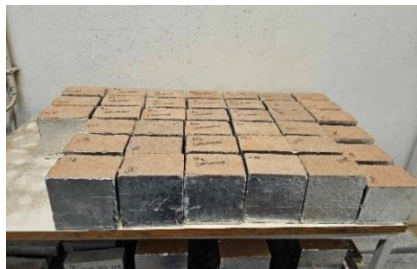
Figura 37 – Ensaio de secagem: provetes selados na câmara seca
