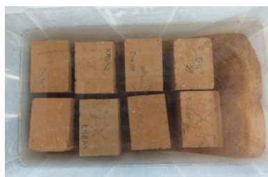
Figura 42 – Dois blocos de UCEB desintegrados (à direita) enquanto os blocos com CP ou CRP mantêm a sua integridade (à esquerda)
