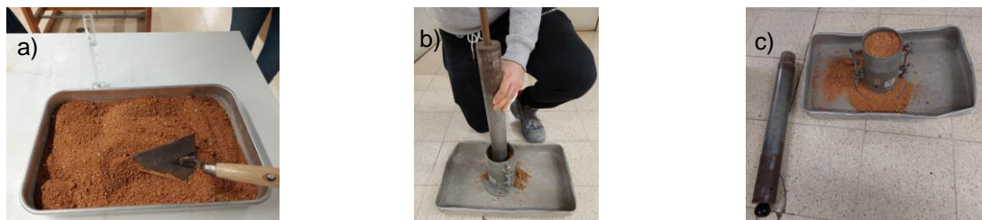
Figura 13 – Ensaio de compactação: a) solo preparado; b) compactação do solo; c) provete após compactação.
