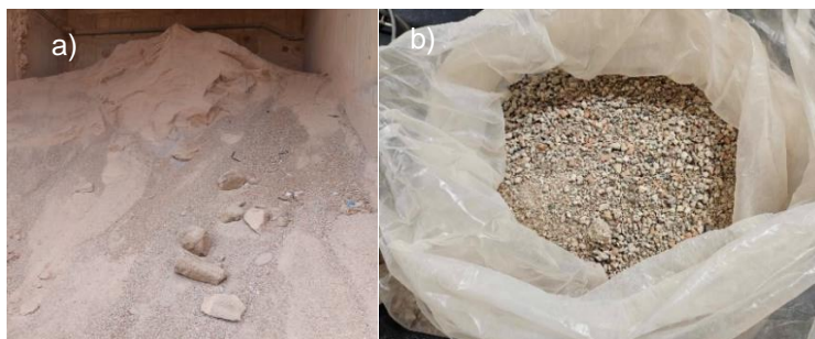
Figura 17 –RCD: Material recolhido e transportado em Big Bags (a); Material em pormenor (b).
