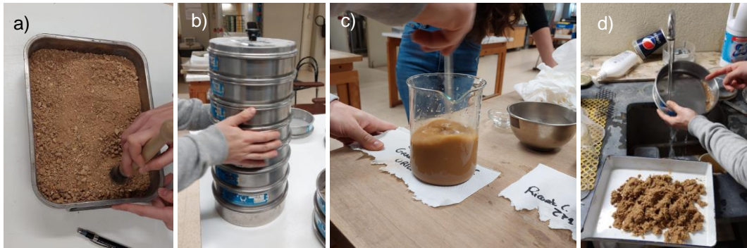
Figura 8 – Análise granulométrica da terra: a) desagregação de aglomerados; b) peneiração; c) mistura com solução de hexametáfosfato de sódio; d) lavagem da amostra.
