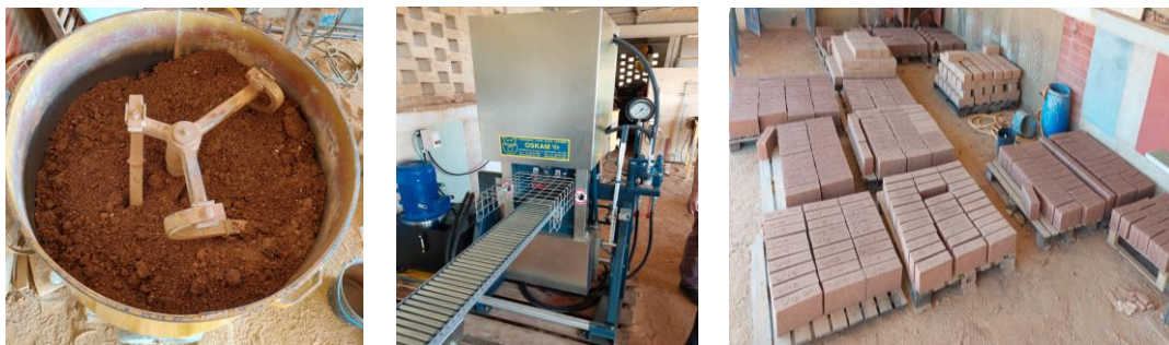
Figura 29 – Produção BTC: a) misturadora de eixo vertical; b) prensa hidráulica; c) arrumação dos blocos
