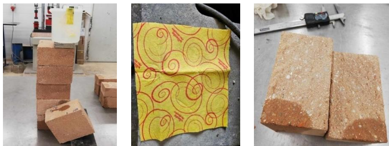
Figura 34 - Drip test : a) Esquema do ensaio; b) Pano absorvente; c) Profundidade de penetração da água
