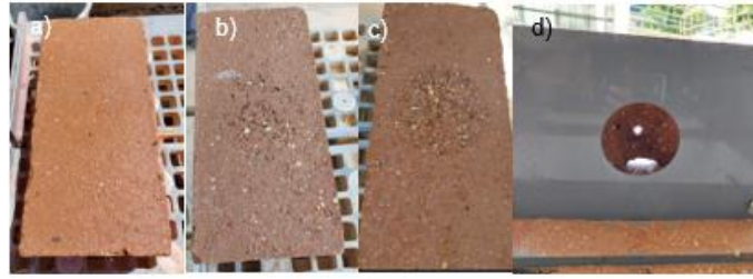
Figura 61– Diferentes níveis de erosão: a) provete CEM8; b) provete CRP8; c) provete CRP4; d) provete UCEB.
