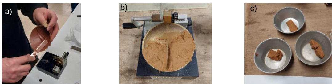
Figura 10 – Determinação do limite de liquidez: a) preparação da concha de Casagrande; b) concha de Casagrande preparada para impactos; c) recolha da amostra para levar à estufa
