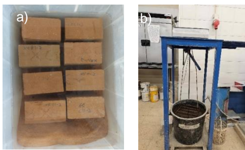
Figura 31 - Ensaio de absorção de água por imersão: a) tanque com os blocos; b) balança hidrostática
