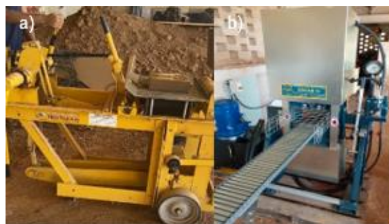
Figura 5 - Prensas utilizadas na compactação dos BTC: a) Prensa mecânica manual Terstaram; b) Prensa hidráulica OSKAM.
