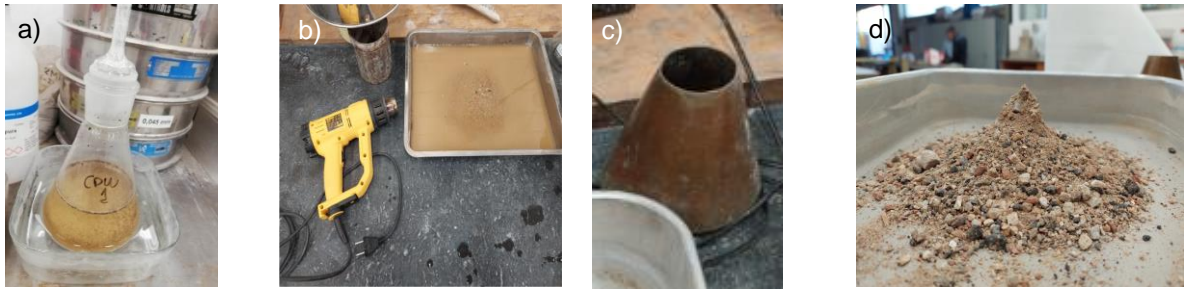
Figura 18 - Determinação da absorção de água das partículas dos solos: a) picnómetro; b) tabuleiro e secador; c) molde de ensaio; d) ensaio completo.
