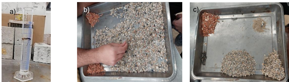
Figura 19 – Determinação fração de agregados nos RCD: a) determinação do volume das partículas flutuantes; b) processo de separação por tipologia; c) separação concluída
