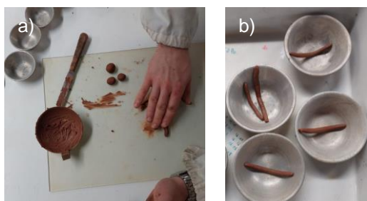
Figura 11 – Determinação do limite de plasticidade: a) rolagem das esferas em filamentos; b) amostras prontas a serem colocadas em estufa.
