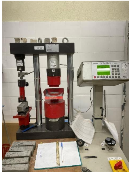
Figura 35 - Prensa Form+Test Seidner 505/200/10 DM1 utilizada nos ensaios de compressão e flexão
