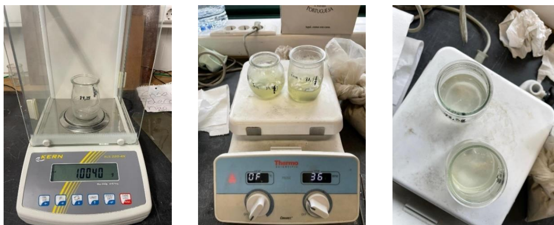
Figura 28 - Ataque ácido - Pesagem inicial da amostra (esquerda), ataque ácido e mistura em agitador magnético (centro) e obtenção de resíduo de areia após o ensaio (direita).
