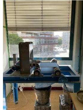
Figura 15 - Equipamento utilizado para a separação magnética dos materiais
