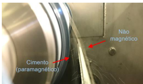
Figura 16 - Exemplo de separação magnética, com efetiva separação dos constituintes de betão (Bogas et al., 2021)
