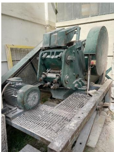
Figura 10 – Britadeira de maxilas com abertura de 20 mm na base, existente no LC
