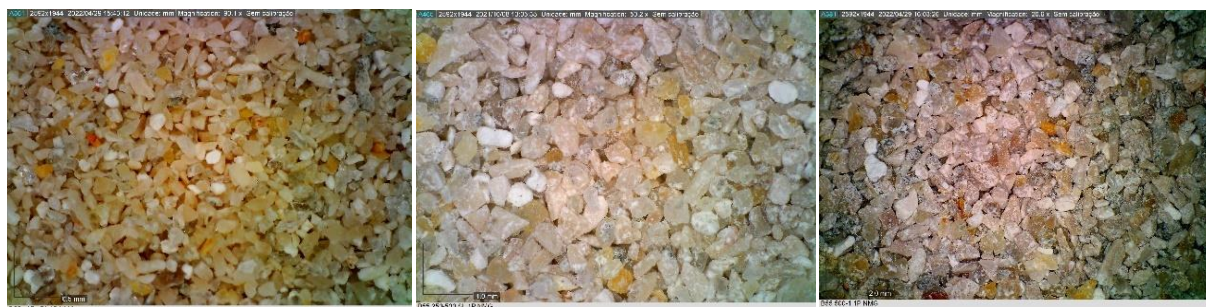
Figura 53 - Análise visual da fração não magnética (areia reciclada) após a primeira passagem das frações: 125-250 \mu\text{m} (esquerda); 250-500 \mu\text{m} (centro); 500-1000 \mu\text{m} (direita) – análise em microscópio digital – B55CL
