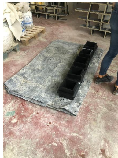
Figura 5 – Moldagem de provetes de PO para posterior reciclagem – provetes cúbicos de 15 cm 3
