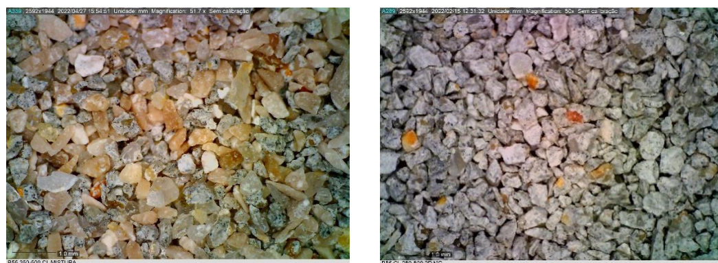
Figura 51 - Análise visual da mistura (esquerda) e fração magnética (direita) após a segunda passagem da fração 250-500 (B55CL) – análise em microscópio digital
