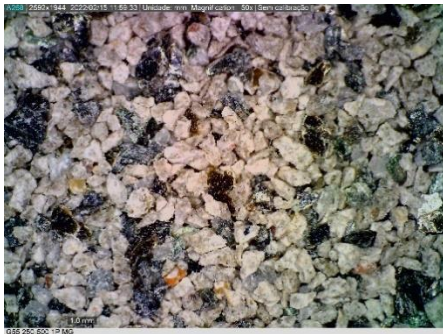
Figura 21 - Primeira etapa de limpeza da mica nos detritos de betão com agregado de natureza granítica.
