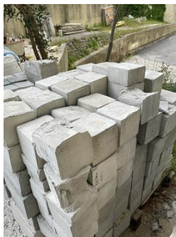
Figura 7 – Cura de provetes de PO em atmosfera exterior até idade de reciclagem
