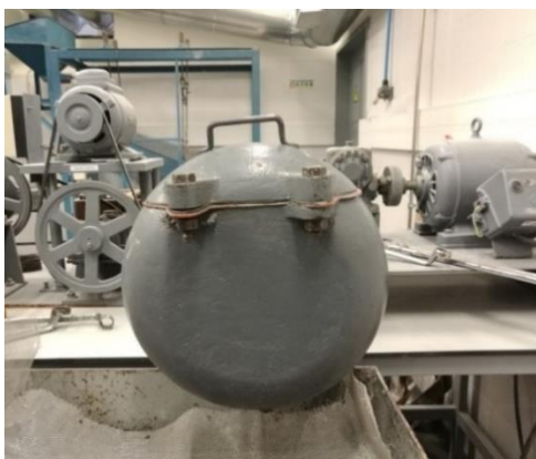
Figura 24 - Moinho de bolas pequeno horizontal utilizado na moagem do resíduo de cimento recuperado do BO para produção de CR.
