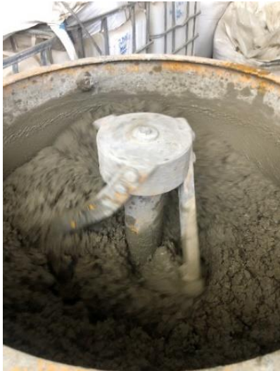
Figura 2 – Misturadora de eixo vertical para a produção de BO
