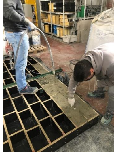
Figura 3 – Moldagem de provetes de BO para posterior reciclagem – provetes de 15x15x30 cm 3
