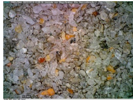
Figura 22 - Segunda etapa de separação dos detritos de betão com agregado de natureza granítica, visando obter agregado pouco contaminado.
