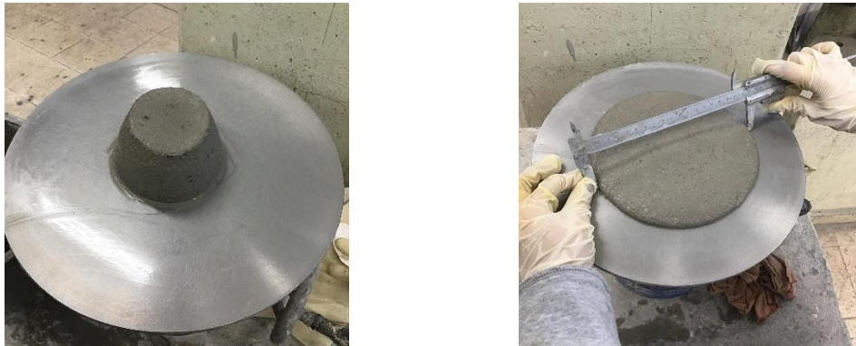
Figura 33 - Ensaio de espalhamento. Após remoção do molde troncocónico (à esquerda) e medição do diâmetro de espalhamento (à direita)
