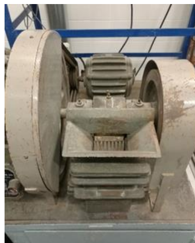
Figura 11 – Britadeira de maxilas pequena, com abertura de 10 mm na base, existente no GEOLAB/IST
