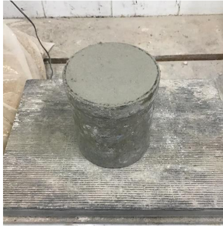
Figura 34 - Ensaio de massa volúmica fresca da argamassa
