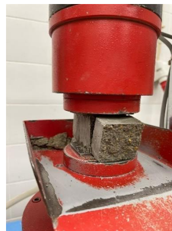
Figura 39 - Rotura à compressão
