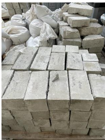
Figura 6 – Cura de provetes de BO em atmosfera exterior até idade de reciclagem
