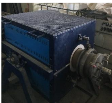
Figura 26 - Forno rotativo utilizado para a termoativação do cimento reciclado
