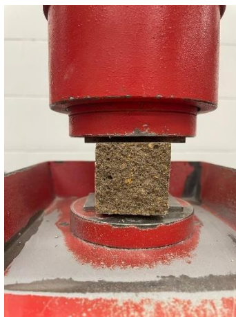
Figura 38 - Ensaio à compressão
