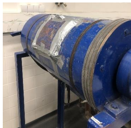
Figura 25 - Moinho de bolas horizontal grande utilizado na moagem do resíduo de cimento recuperado da PO, para produção de CR.
