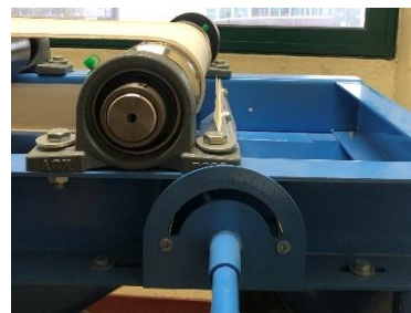
Figura 17 - Divisor para ajuste do ponto de separação da trajetória dos diferentes tipos de partículas
