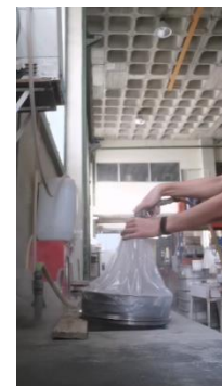
Figura 20 – Peneiração a seco com auxílio de ar comprimido
