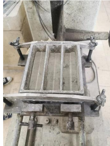
Figura 32 - Moldagem e compactação das argamassas.
