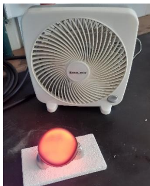
Figura 3.11 - Arrefecimento acelerado de clínquer com auxílio de ventilador
