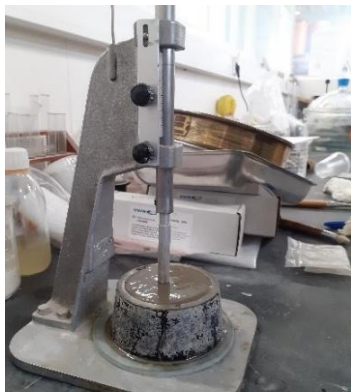
Figura 3.18 - Ensaio de consistência de pasta - Vicat
