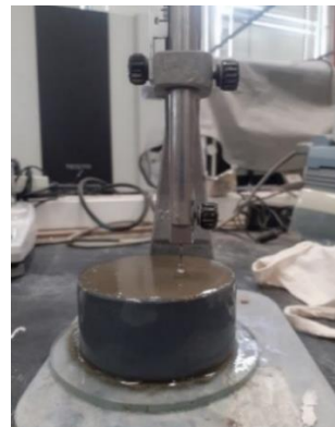
Figura 3.19 - Ensaio de determinação de tempo de fim de presa - Vicat
