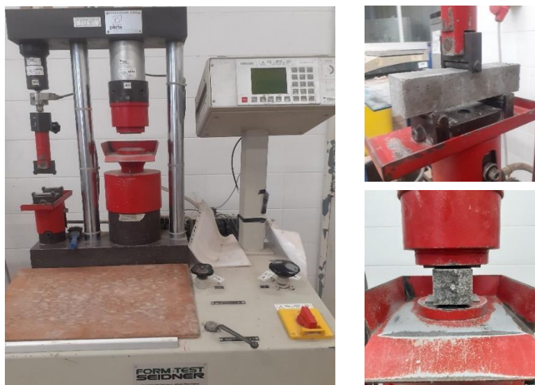
Figura 3.26 - Ensaio de resistência mecânica em argamassas
