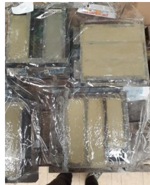
Figura 3.23 - Cura de provetes imediatamente após moldagem
