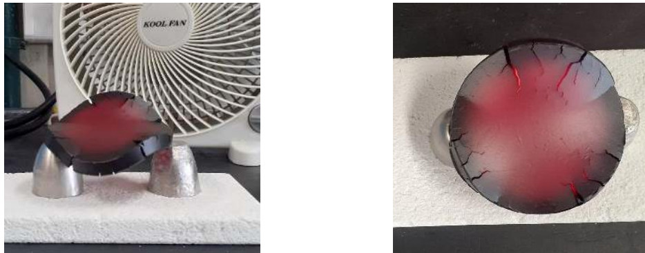
Figura 4.3 - Aspeto do clínquer K100RP tratado a 1350 °C, após a saída do forno e arrefecimento
