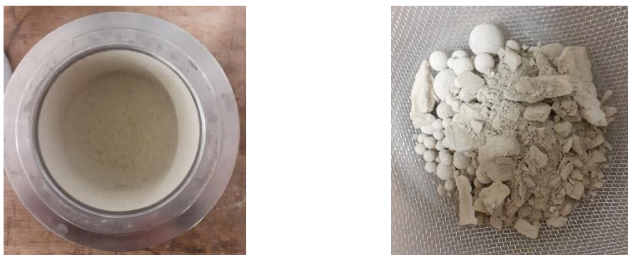
Figura 4.6 - Adesão do cimento às paredes da cuba de moagem (esquerda) e aglomeração das partículas de cimento (direita). Moagem a 400 rpm durante 20 minutos.
