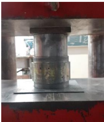
Figura 3.7 – Prensagem para conformação da pastilha de clínquer
