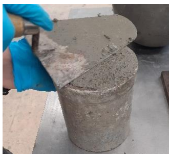
Figura 3.25 - Ensaio para a determinação de massa volúmica fresca da argamassa
