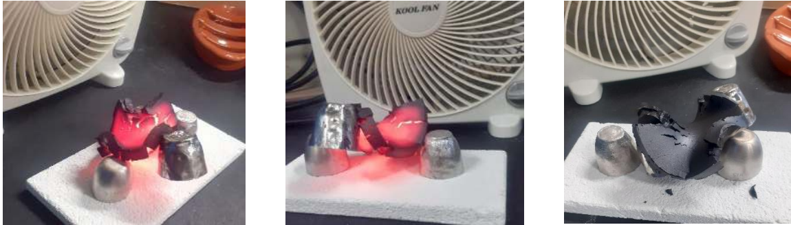
Figura 4.2 - Aspeto do clínquer K100RP tratado a 1450 °C, após a saída do forno e arrefecimento
