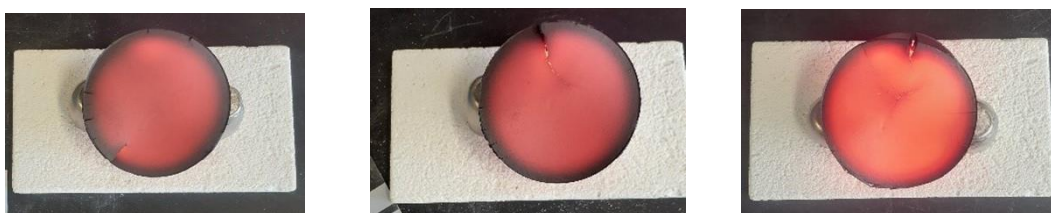
Figura 4.4 - Aspeto do clínquer KRP tratado a 1350 °C (esquerda), 1400 °C (centro) e 1450 °C (direita), após a saída do forno
