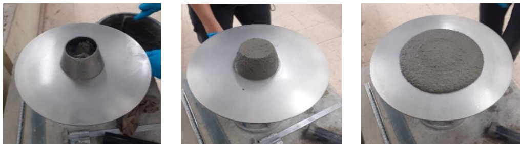
Figura 3.24 - Realização do ensaio de espalhamento: preenchimento do cone (esquerda); compactação através da mesa de espalhamento (centro); espalhamento final (direita)
