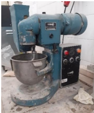
Figura 3.22 - Misturadora utilizada na produção das argamassas
