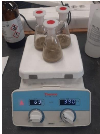
Figura 3.17 - Agitação magnética de clínquer para determinação de teor de CaO
