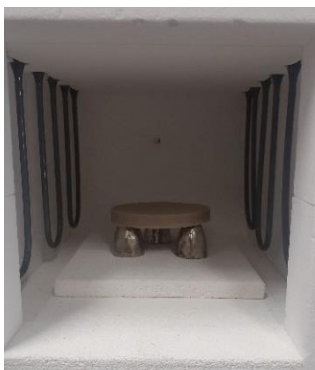
Figura 3.10 - Posicionamento de pastilha na mufla para posterior clinquerização
