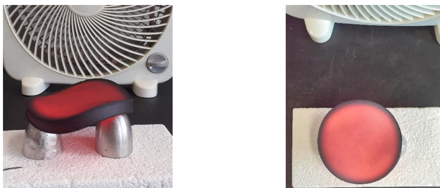
Figura 4.5 - Aspeto do clínquer KRSB tratado a 1450 °C, após a saída do forno e arrefecimento
