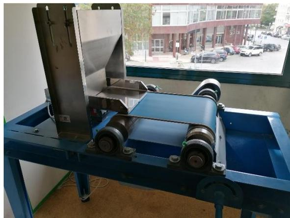
*Figura 3.11 - Equipamento de separação magnética*
