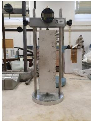
Figura 3.20 - Retração Axial no LNEC
