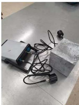
Figura 3.17 - Medição da velocidade de propagação de ultrassons
