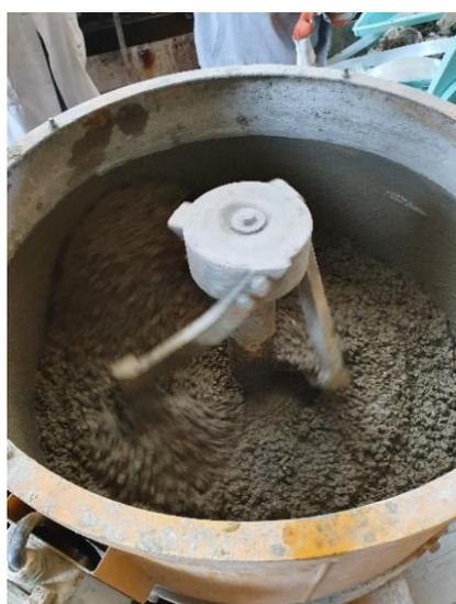
*Figura 3.1 - Betoneira de eixo vertical utilizada para a produção de betão*
