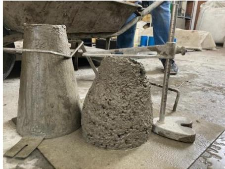
Figura 3.15 - Ensaio de Abaixamento
