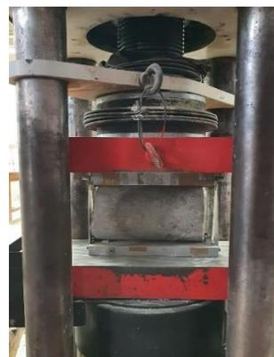
Figura 3.18 - Ensaio à tração por compressão diametral na prensa TONI PACT 3000
