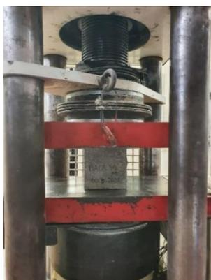
Figura 3.16 - Ensaio à compressão na prensa TONI PACT 3000
