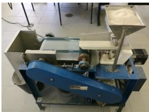
Figura 4.1. Equipamento de rolo magnético utilizado no presente trabalho do LNEG (Porto)
