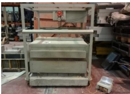
Figura 4.33. Forno horizontal do LC em funcionamento (com termopares)
