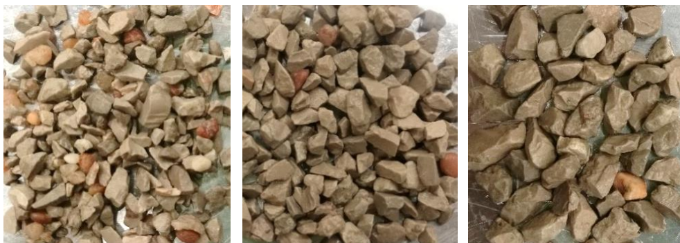
Figura 3.26. Material proveniente do tratamento a 400 °C: frações entre 2-4, 4-6,3 e 6,3-8 mm com superfície limpa, respetivamente.
