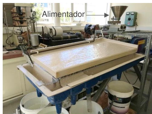
Figura 4.14. Mesa Wilfley utilizada no presente trabalho do LNEG (Porto)
