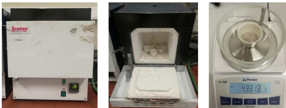
Figura 3.3. Mufla, cadinhos cerâmicos e balança utilizados no ensaio de AMT
