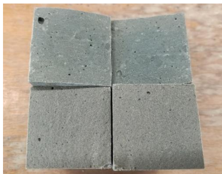
Figura 4.36. Diferença visual dos provetes produzidos: CR/REF (cima) e CR/Bet (baixo)
