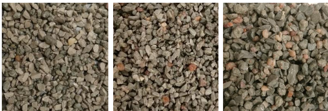
Figura 3.25. Amostras do material proveniente do tratamento térmico a 300, 400 e 500 °C, da esquerda para a direita, respetivamente.
