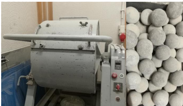
Figura 3.16. Equipamento de Los Angeles do LC
