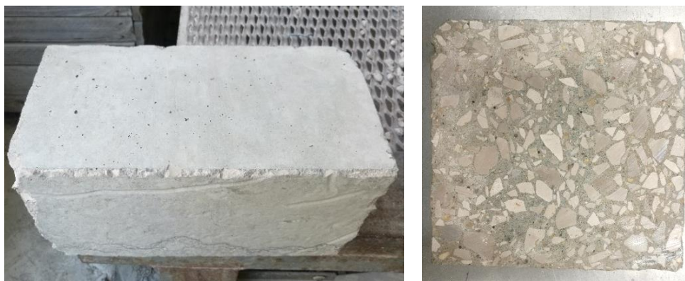
Figura 3.2. Exemplo de blocos de betão utilizados no estudo e corte transversal de um bloco
