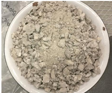
Figura 3.18. Betão britado proveniente da britadeira de maxila do LC
