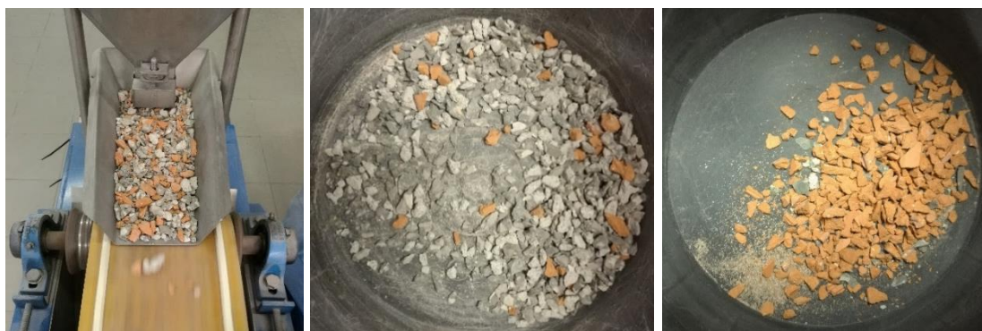
Figura 4.13. RC&D simulado (à esquerda), detrito de betão (no meio) e material cerâmico (à direita) resultante da separação magnética (fração menos eficiente de 6,3-12 mm, após uma passagem)
