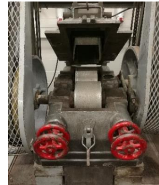
Figura 3.15. Moinho de rolos do GEOLAB
