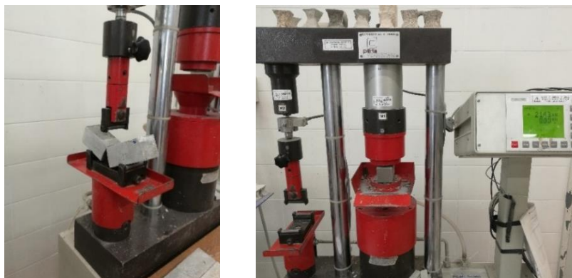
Figura 3.9. Ensaio de resistência à flexão (esquerda) e ensaio de resistência à compressão (direita)
