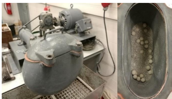
Figura 4.31. Moinho de bolas de Denver do GEOLAB/IST
