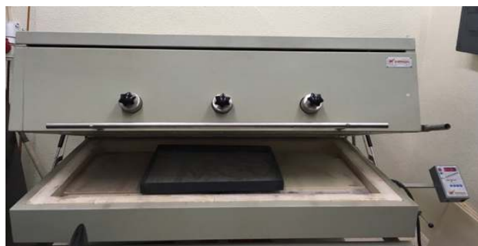
Figura 3.7: Forno horizontal Termocontrol 3PR utilizado para a desidratação do cimento hidratado.
