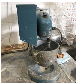
Figura A.4 1: Mistura de eixo vertical com dispositivo automático para controlo dos tempos de amassadura, utilizada para produção de pastas e argamassas.
