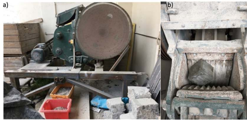
Figura 3.1: a) Britadeira de maxilas utilizada; b) Entrada dos provetes na britadeira.
