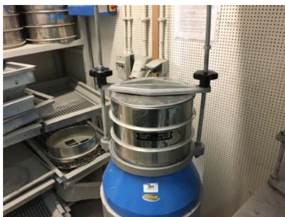
Figura 3.4: Agitador eletromagnético Matest e respectivos peneiros utilizados na peneiração.
