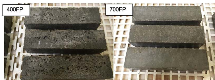
Figura 3.12: Provetes produzidos com material de dimensões inferiores a 45 µm termicamente ativado a 400°C e 700°C.
