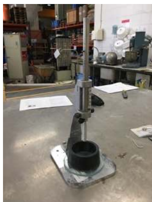
Figura A5. 1: Aparelho de Vicat utilizado para determinação de tempos de presa e consistências normais em pastas, munido de agulha.
