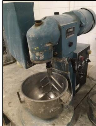
Figura 3.11 – Misturadora de eixo vertical e pá de mistura utilizadas nas amassaduras
