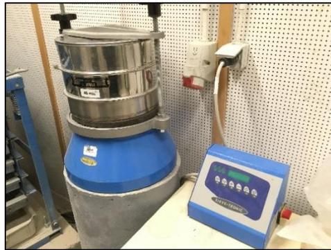
Figura 3.6 – Agitador de peneiros e peneiros adotados na crivagem da PO moída
