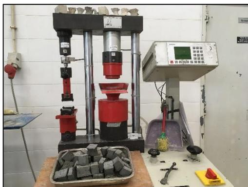
Figura 3.17 – Prensa utilizada nos ensaios de resistência à flexão e compressão
