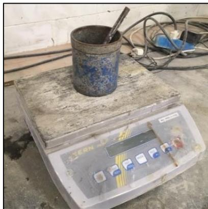
Figura 3.15 – Equipamento utilizado para determinação da massa volúmica fresca das argamassas
