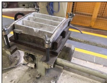
Figura 3.12 – Mesa de compactação e moldes utilizados na produção dos provetes de argamassa
