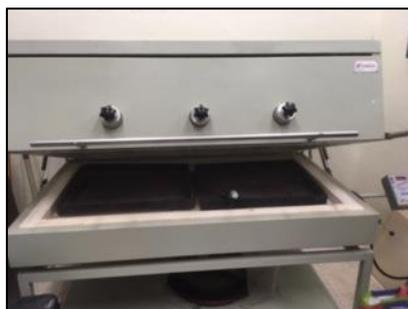
Figura 3.9 – Forno elétrico TERMOCONTROL 3PR, usado no primeiro tratamento
