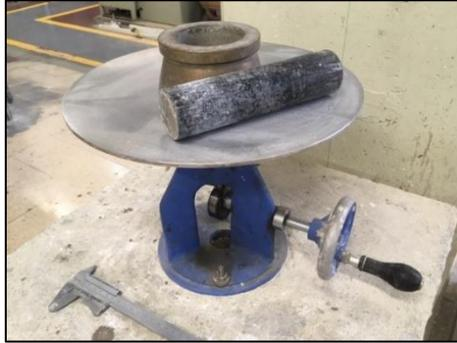
Figura 3.14 – Equipamento utilizado nos ensaios de espalhamento, segundo a norma EN 1015-3
