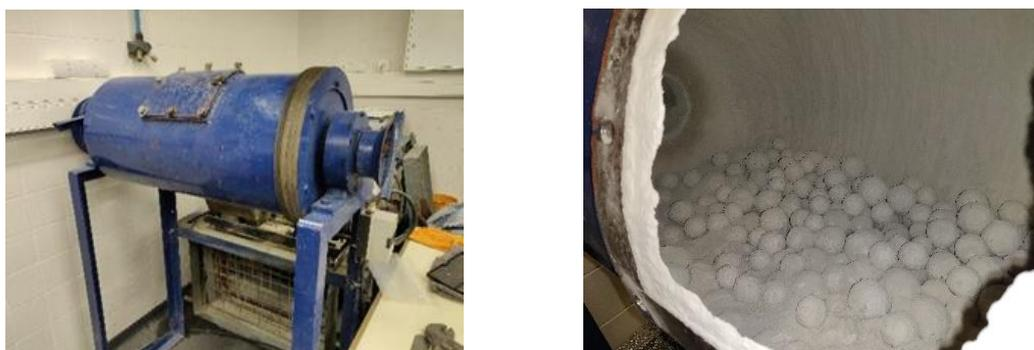
Figura 11: Moinho de Bolas do LAMPIS (à esquerda) e respetiva carga de bolas utilizada no interior do moinho de bolas (à direita).
