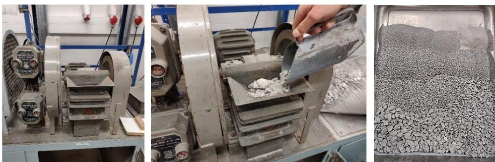
Figura 9: Britagem secundária na britadeira de maxilas do LAMPIST (à esquerda) e respectiva distribuição granulométrica da pasta de origem após britagem secundária (à direita).
