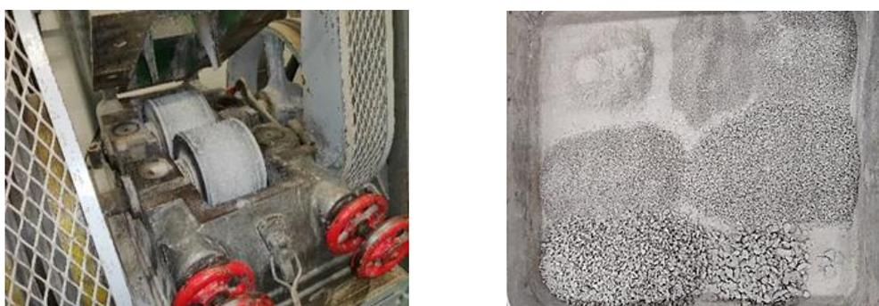
Figura 10: Moinho de Rolos do LAMPIST (à esquerda) e respectiva distribuição granulométrica da pasta de origem após moinho de rolos (à direita).
