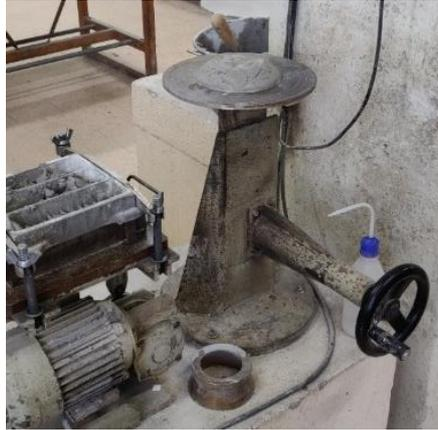
Figura 22: Ensaio de espalhamento.
