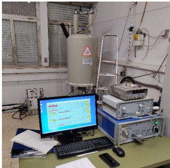
Figura 25: Ensaio de Ressonância magnética nuclear.
