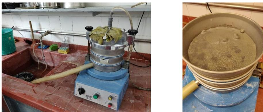
Figura 12: Crivagem a húmido (à esquerda) e aglomeração no interior dos crivos (à direita).
