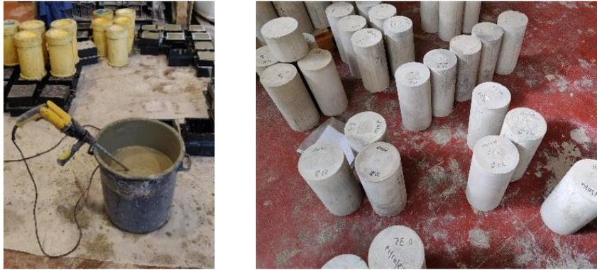
Figura 7: Produção de pastas de origem (à esquerda) e provetes endurecidos de pasta de origem (à direita).
