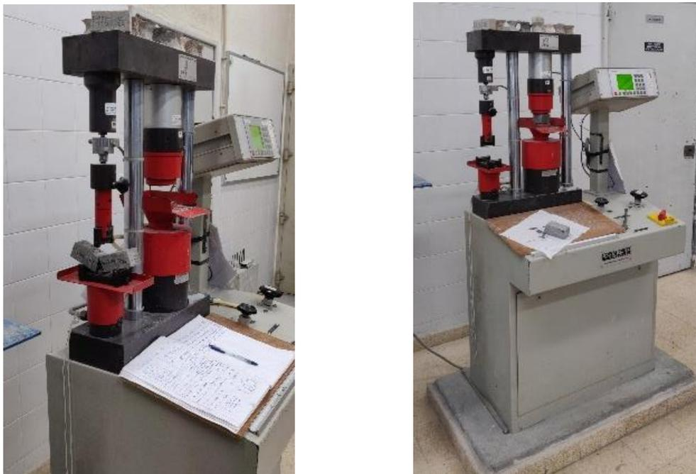
Figura 26: Prensa hidráulica utilizada nos ensaios de resistência mecânica.
