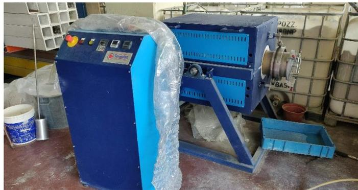
Figura 17: Forno rotativo localizado no LC de DeCivil.
