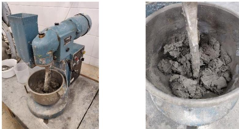
Figura 18: Misturadora (à esquerda) e mistura de pasta de CR (à direita).
