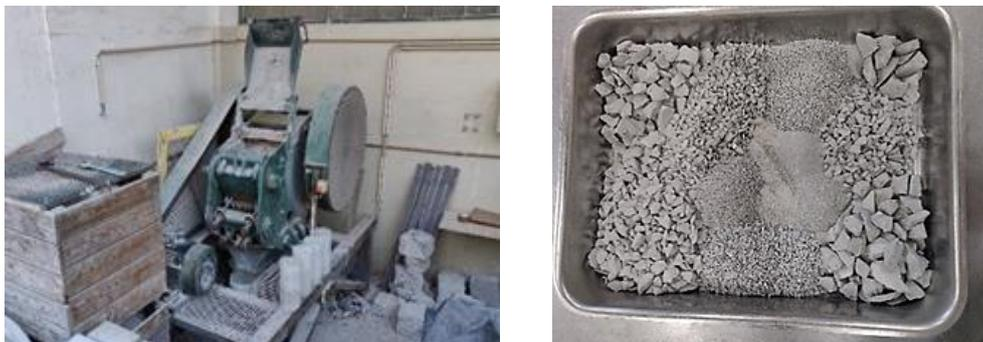
Figura 8: Britadeira de maxilas do LC do DeCivil (à esquerda) e respectiva distribuição granulométrica da pasta de origem após britagem primária (à direita).
