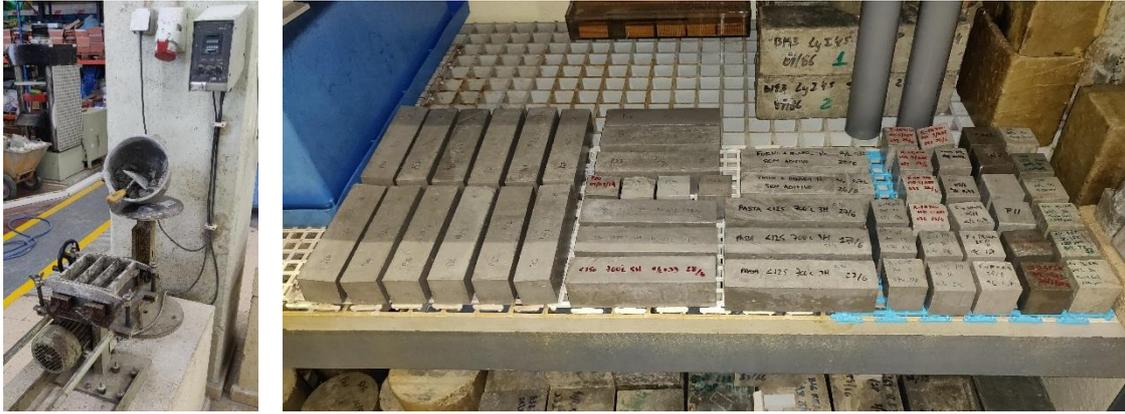
Figura 19: Mesa de compactação (à esquerda) e cura de provetes em câmara húmida (à direita).
