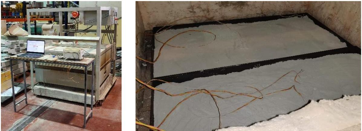
Figura 15: Forno horizontal de civil (à esquerda) e posicionamento dos termopares no interior do forno (à direita).
