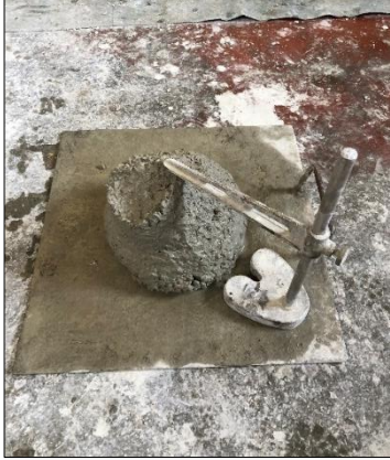
Figura 3.16- Ensaio de abaixamento segundo NP EN 1 2350-2
