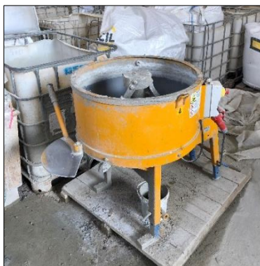
Figura 3.8 - Betoneira utilizada para produção de betão
