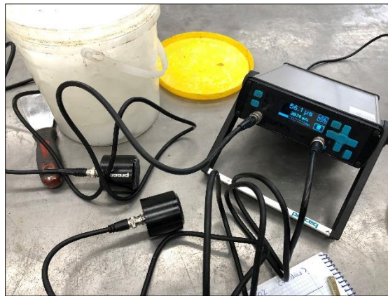
Figura 3.18 - Equipamento de medição de velocidade de propagação de ultrassons
