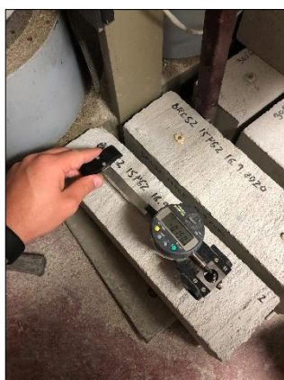
Figura 3.19 - Equipamento de medição Mitutoyo em ensaio de retração
