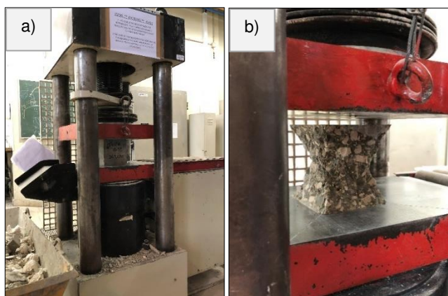
Figura 3.20 – a) Prensa TONI PACT 3000 b) Provete após ensaio de compressão
