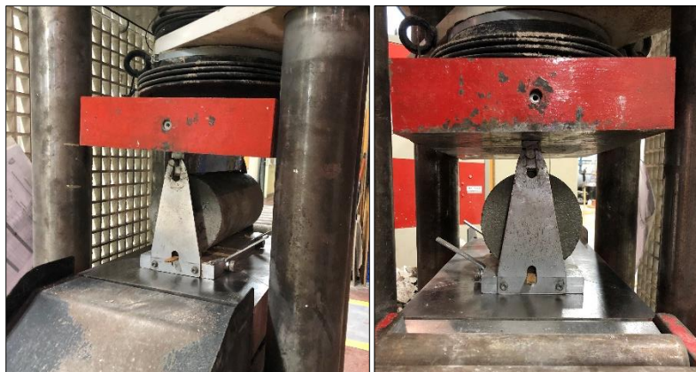
Figura 3.21 – Ensaio à tração por compressão diametral
