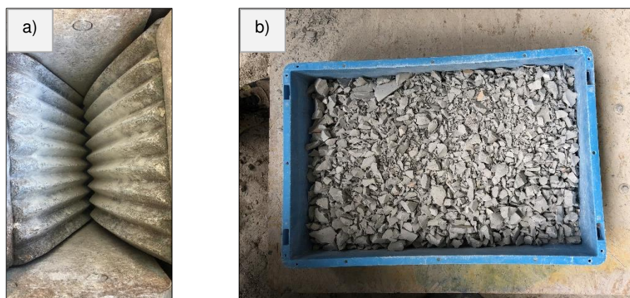
Figura 3.2 - a) Abertura da maxila da britadeira b) Partículas após primeira fase de britagem
