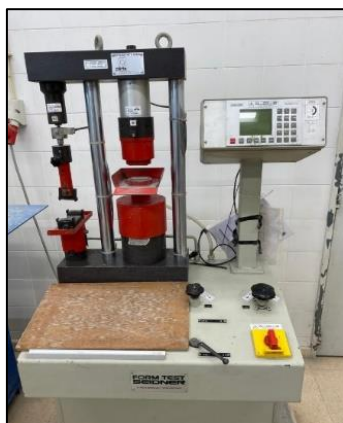
Figura 3.13 - Prensa Form+Test Seidner 505/200/10 DM1 utilizada nos ensaios de compressão e flexão.
