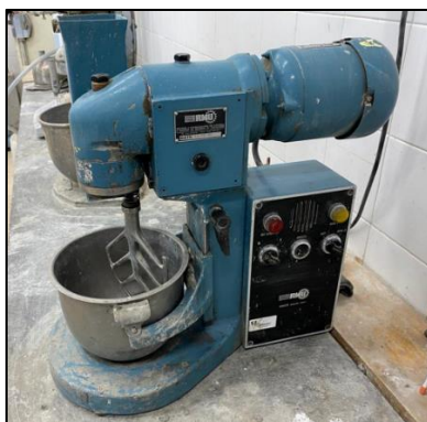
Figura 3.7 – Misturadora utilizada na produção das argamassas.
