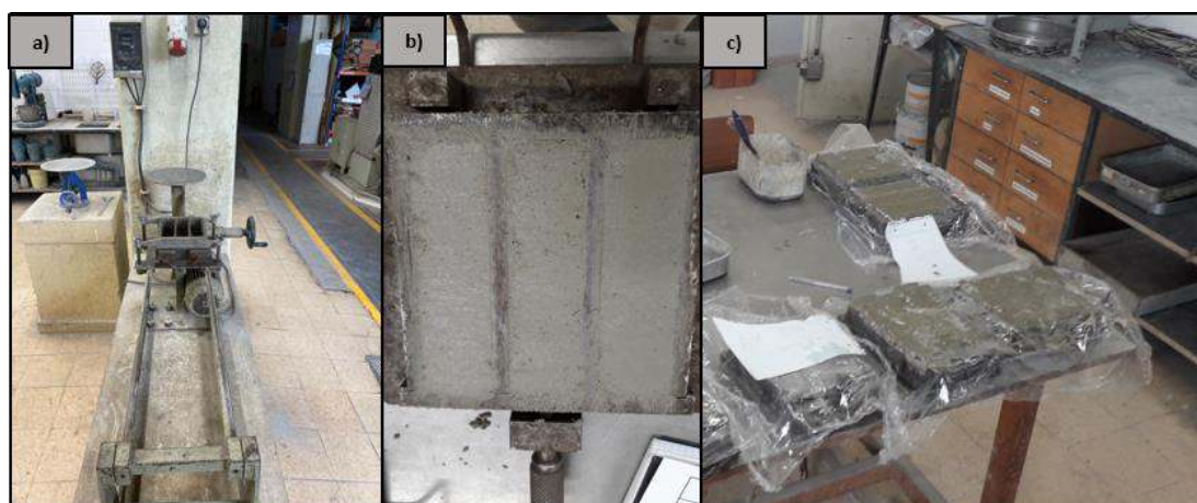
Figura 3.9 – a) Mesa de compactação; b) Molde preenchido com argamassa e rasado; c) Colocação de película plástica para evitar evaporação.
