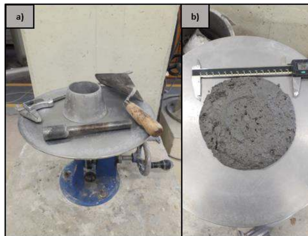
Figura 3.11 – a) Materiais utilizados no ensaio de espalhamento; b) Medição do diâmetro resultante do ensaio.
