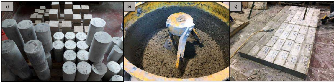
Figura 3.1 – a) Provetes de PO; b) Misturadora durante a produção do BO; c) Provetes de BO. Adaptado de Real, 2019.
