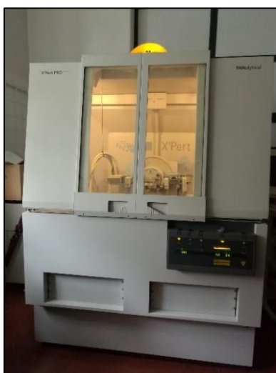
Figura 3.6 - PANalytical X'Pert Pro utilizado para a análise DRX.
