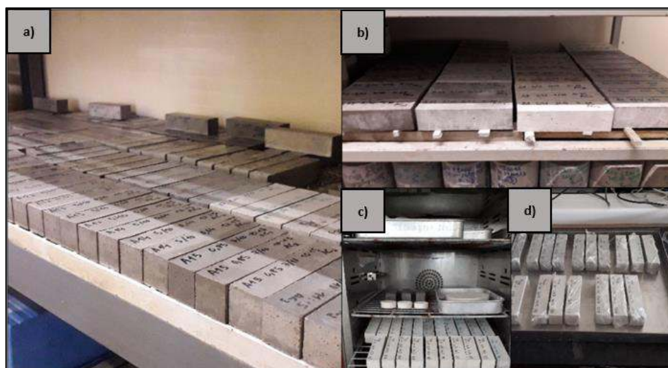
Figura 3.10 – a) Armazenamento em câmara húmida; b) Armazenamento em câmara seca; c) Secagem em estufa; d) Colocação de película plástica antes do ensaio de absorção capilar.
