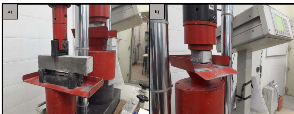
Figura 3.14 – a) Ensaio de resistência à flexão; b) Ensaio de resistência a compressão.
