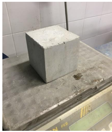
Figura 27 – Medição da massa do provete seco
