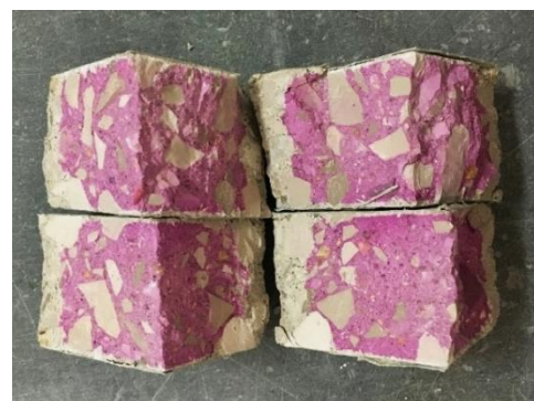
Figura 41 - Provetes partidos depois de aplicada a solução de fenolftaleína
