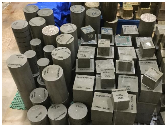
Figura 25 - Provetes na câmara húmida com HR superior a 95%
