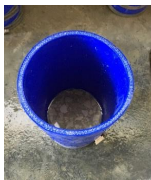
Figura 35 - Colocação dos provetes nas mangas de borracha
