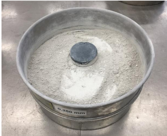
Figura 13 - Peneiração no peneiro de 250 \mu\text{m}
