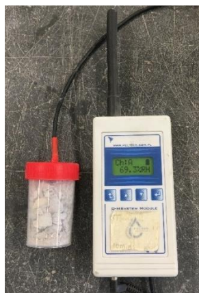
Figura 33 – Medição da humidade e temperatura com recurso ao humidímetro
