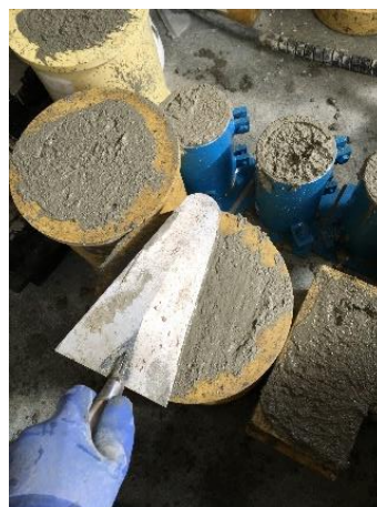
Figura 24 - Acabamento das faces de betonagem
