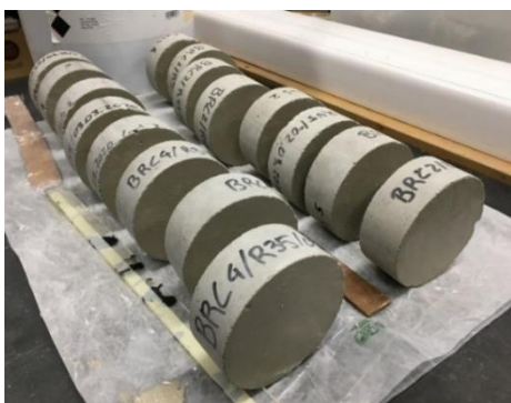
Figura 40 - Provetes depois de impermeabilizadas as faces
