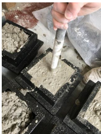
Figura 23 - Vibração do betão
