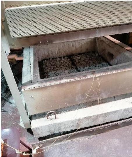
Figura 18 - Forno horizontal do LERM para produção de ART
