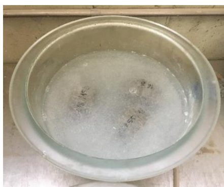
Figura 34 - Provetes no exsicador com a solução de \text{Ca(OH)}_2
