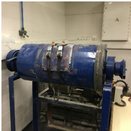
Figura 11 - Moinho de esferas de aço do GEOLAB
