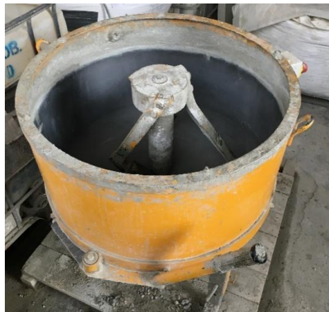
Figura 22 – Betoneira de eixo horizontal com descarga de fundo
