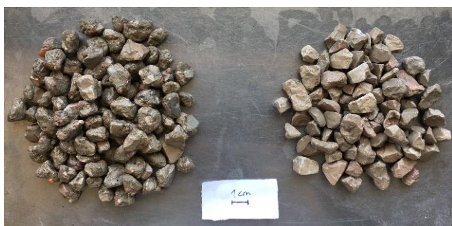
Figura 20 - ART do forno rotativo, fração 8 - 12,5 mm
