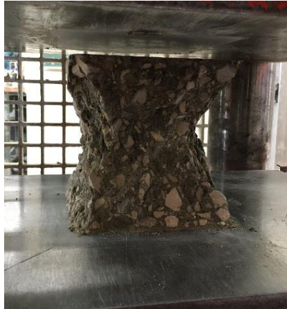
Figura 28 – Cubo ensaiado com rotura satisfatória
