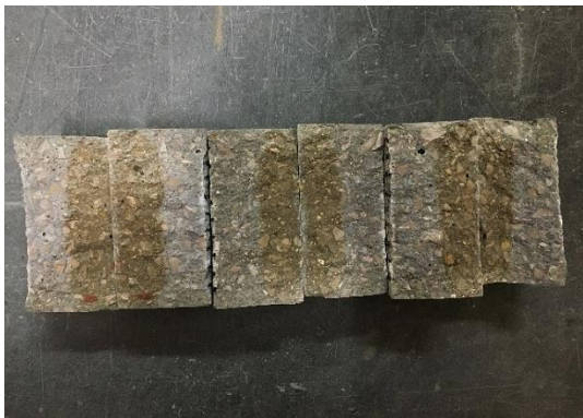
Figura 38 - Provetes depois de aplicada a solução de nitrato de prata
