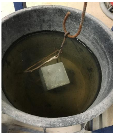
Figura 26 – Medição da massa do provete imerso
