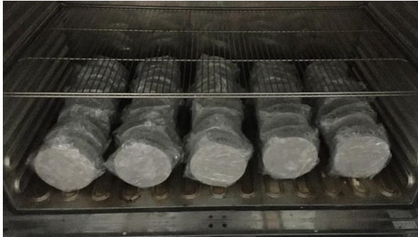
Figura 29 – Provete em estufa ventilada a 50 °C
