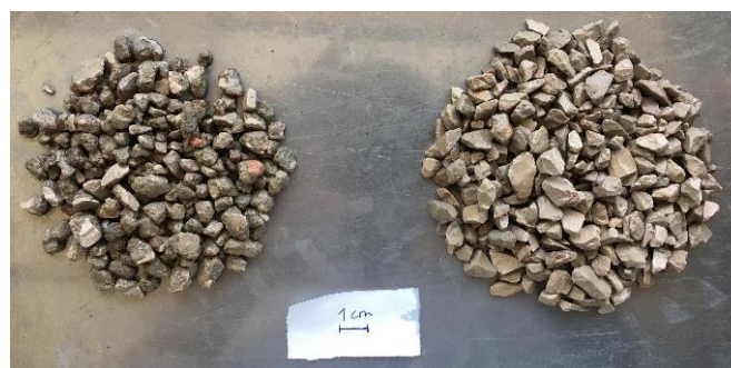
Figura 21 - ART do forno rotativo, fração 4 - 8 mm
