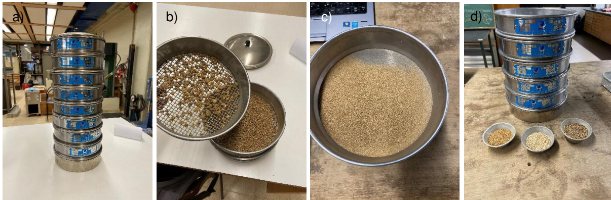
Figura 12 - Peneiração: a) séries de peneiros; b) e c) solo peneirado; d) cápsulas com as amostras da terra após a peneiração húmida.
