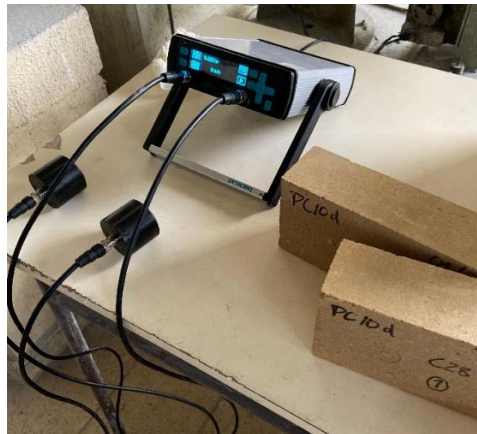
Figura 23 - Ensaio de velocidade de propagação de ultrassons.
