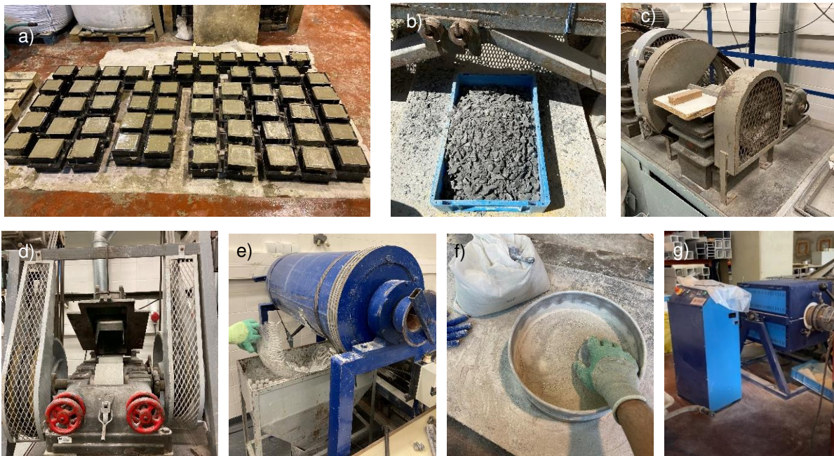
Figura 15 - Produção do cimento reciclado: a) produção dos provetes de pasta de cimento; b) britagem dos provetes; c) balde de maxilas; d) moinho de rolos; e) moinho de bolas; f) peneiração do cimento; g) forno de câmara rotativa.
