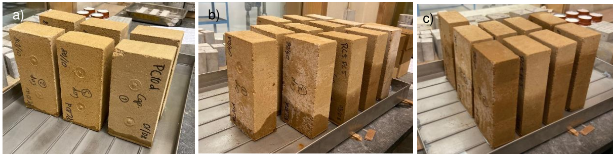
Figura 66 – Fases do ensaio de absorção por capilaridade: a) inicial; b) 24 horas; c) 72 horas.
